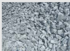
将原料煤干馏制成的焦炭
